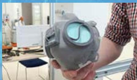
Masque imprimé en 3D permettant de n'utiliser qu'une partie de masque chirurgical.
